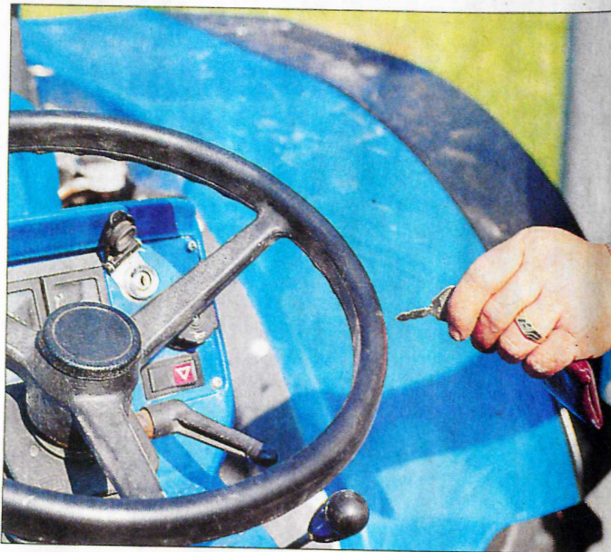
Einfache Massnahme mit grosser Wirkung: Bei Fahrzeugen nach dem Gebrauch den Schlüssel abziehen.
